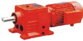
斜齿轮减速机 Helical gears - worm reducer 可底脚、法兰安装 可配各类电机或双轴型 功率：0.12~160kw 转矩：85~18000N.m 传动比：1.4~28000
