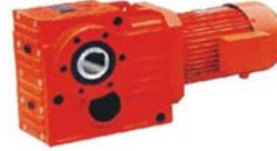
斜齿轮-伞齿轮减速机 Helical - bevel gear reducer 可底脚或法兰安装 可配各类电机 可电机直联型或双轴型 功率：0.12~200kw 转矩：200~50000N.m 传动比：5~33000
