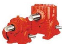
蜗轮蜗杆减速机 Worm reducer 可底脚、法兰、空心轴安装 功率：0.12~160kw 转矩：50~28000N.m 传动比：5~63
